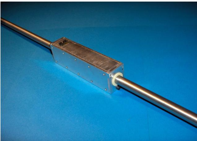
La trasmissione diretta del moto rende TM1124 efficace e preciso. La velocità raggiungibile è superiore a quella ottenibile da un sistema vite-madrevite. Il sistema è auto-sostentante, in quanto dotato di guide integrate che non richiedono lubrificazione e dal funzionamento silenzioso e pulito. Esse possono essere facilmente sostituite essendo ad innesto rapido.
