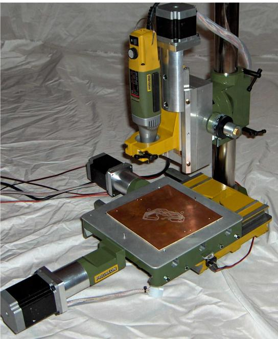
La tecnica di asportazione meccanica del rame evita il pericolo di sottoincisione degli isolamenti: le tracce di rame risultano avere sezione costante e netta.
